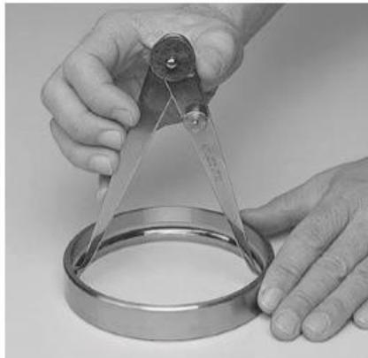
*Cuando instrumentos de medición sin graduación se sujetan levemente por los dedos, es posible sentir diferencias in mas de medidas.*
