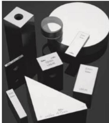
*Los bloques patrón son usados en cualquier industria como patrón básico y tienen exactitud de centésimas de micrón o millonésimas de pulgadas.*
