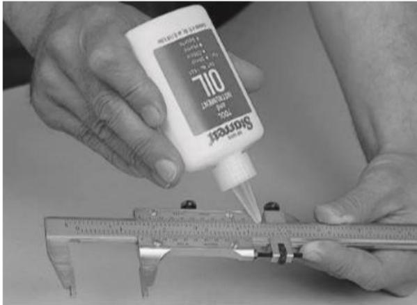
*Un aceite para instrumentos de alta categoría debe ser regularmente aplicado sobre los instrumentos de precisión.*
