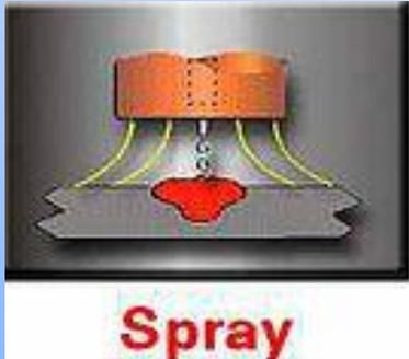
**TRANSFERENCIA POR ARCO SPRAY.** El material se transfiere en forma de pequeñas gotas menores que el diámetro del alambre. Se obtiene con altas intensidades y altos voltajes. Los gases inertes favorecen este tipo de transferencia. Se utiliza este tipo de transferencia para el soldeo en posición horizontal y para el soldeo de espesores gruesos. Con este tipo de transferencia se consiguen grandes tasas de deposición y rentabilidad en la soldadura.
