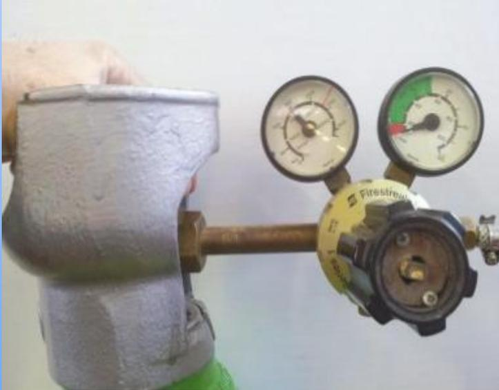
El caudal de gas a utilizar dependerá de las condiciones en las que estemos trabajando, Pero por lo general podemos calcularlo a base de 10 veces el diámetro del hilo. Ej. Hilo de 0,8mm x 10 = 8 L/min.
