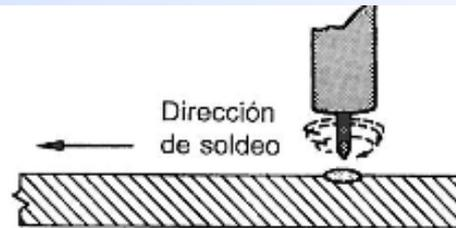
(a) Formación del baño de fusión, mediante un movimiento circular o de lado a lado
