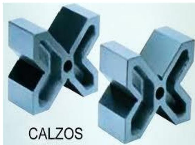
Se utiliza apoyando una de las caras de la estructura o del cubo sobre el mármol de trazar y sobre este la pieza. Debiendo de estar siempre bien apoyado sobre el mármol.
