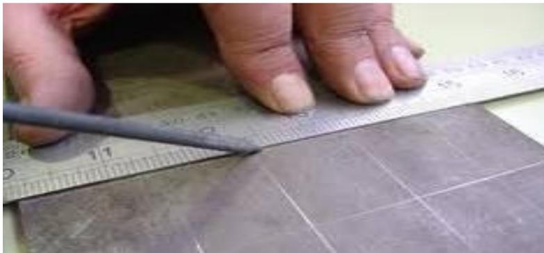
El **trazado al aire o espacial** es el que efectuamos sobre los distintos planos o superficies de una pieza en el espacio (en 3 dimensiones), reproduciendo en la pieza todas las indicaciones del croquis o plano. Es muy usado en las operaciones de montaje o de ajuste.
